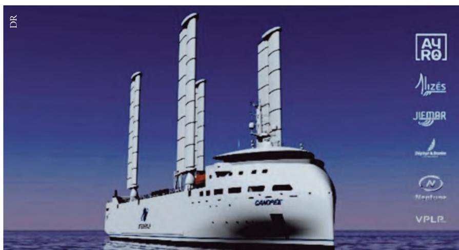
★ Les Oceanwings® apportent une puissance propulsive dès 5° d'angle de vent apparent et sont utilisables de 0 à 80 nœuds de vitesse de vent apparent. Elles peuvent supporter des vents de plus de 140 nœuds et peuvent être affalées en cas d'absence de vent et pour les manœuvres portuaires.
