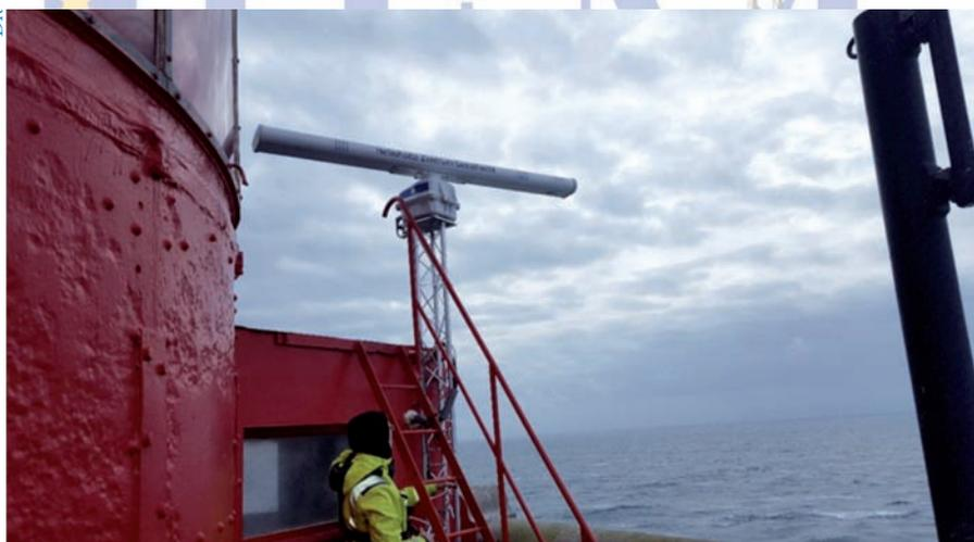
*Dispositifs expérimentaux sur le phare de la Jument, pour réaliser des mesures aidant au dimensionnement des éoliennes offshore.*
